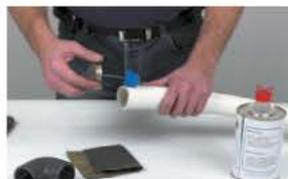
Enduire d'une couche uniforme et régulière, d'abord sur l'entrée de l'ombituro puis sur la totalité du bout mâle, en terminant dans le sens longitudinal.
