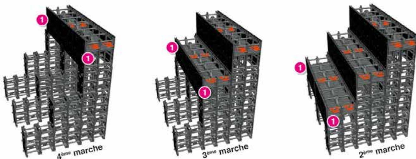
Montage des marches par clipsage de deux 1/2 blocs escalier
