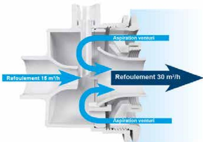
Notre buse permet grâce au principe du venturi d'augmenter le débit de 15 m<sup>3</sup>/h jusqu'à 30 m<sup>3</sup>/h gratuitement, ce qui nous donne un rendement exceptionnel !
