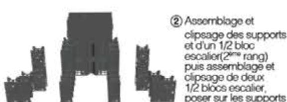
② Assemblage et clipsage des supports et d'un 1/2 bloc escalier (2<sup>ème</sup> rang) puis assemblage et clipsage de deux 1/2 blocs escalier, poser sur les supports
