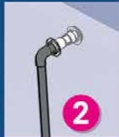
Couper la traversée de paroi au ras du mur, et coller un morceau de tube à l'intérieur, puis se reprendre sur ce tube pour coller soit directement le coude (en Ø 50), ou soit en intercalant une réduction 50/63 (cas du Ø 63).
