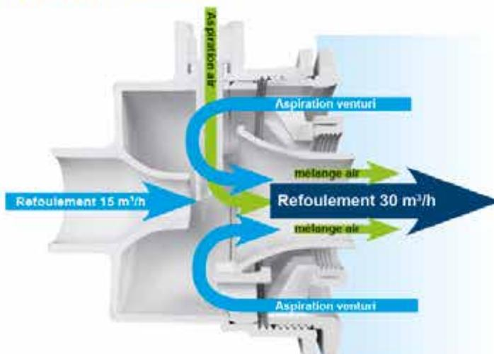
En ouvrant simplement le bouton de contrôle d'air la buse va aspirer de l'air pour le mélanger en sortie de buse et procurer un délicieux torrent oxygéné de 30 m<sup>3</sup>/h pour une détente maximum ...
