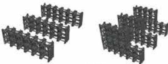
③ Assemblage et clipsage des 1/2 blocs escalier et 1/2 blocs plage puis on pose la marche sur les supports
