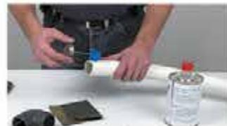
Enduire d'une couche uniforme et régulière, d'abord sur l'entrée de l'emboîture puis sur la totalité du bout mâle, en terminant dans le sens longitudinal.
