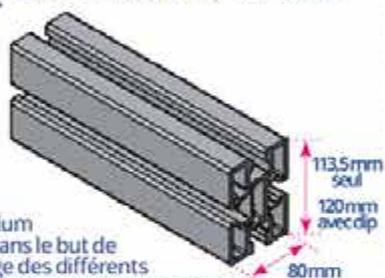
Poutre en aluminium anodisé conçue dans le but de faciliter le montage des différents composants des couvertures automatiques avec caillebotis immergés. Les 4 encoches permettent des assemblages symétriques sur lesquels viennent se clipser les caillebotis, les contrepois et les déflecteurs. (Voir page 59)
