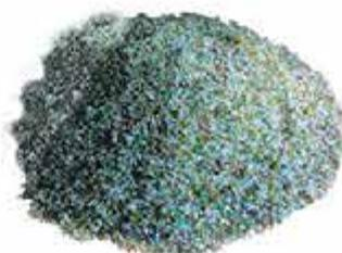
La charge filtrante peut-être du sable ou du verre : on superpose deux granulométries, fine et gravier.
