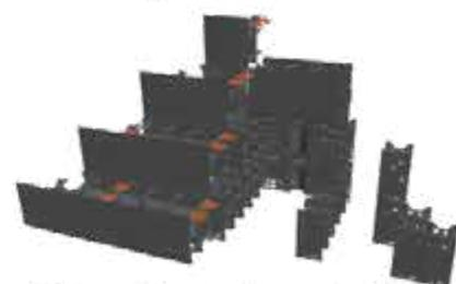
③ Assemblage et clipsage des 1/2 blocs escalier, des blocs escalier 45° et des blocs 2x45° puis on pose les marches sur les supports.
