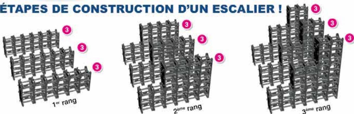
Assemblage par clipsage des supports
